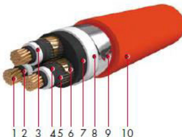
Мал. 25.8. Трижильний броньований кабель з ізоляцією із зшитого поліетилену в ПВХ-оболонці з жилами в індивідуальному екрані: 1 - мідна (алюмінієва) кругла ущільнена струмопровідна жила; 2 - екструдований екран по струмопровідним жилам з напівпровідного матеріалу; 3 - ізоляція з пероксидно-зшитого поліетилену; 4 - екструдований екран по ізоляції з напівпровідного матеріалу; 5 - екран з напівпровідної стрічки, намотаної по спіралі; 6 - екран з мідних дротів, поверх яких накладена мідна стрічка; 7 - внутрішня оболонка з ПВХ, накладена з одночасним заповненням проміжків між жилами; 8 - розділювальна оболонка з полівінілхлоридного пластикату; 9 - броня з двох сталевих оцинкованих стрічок; 10 - оболонка з поліетилену
