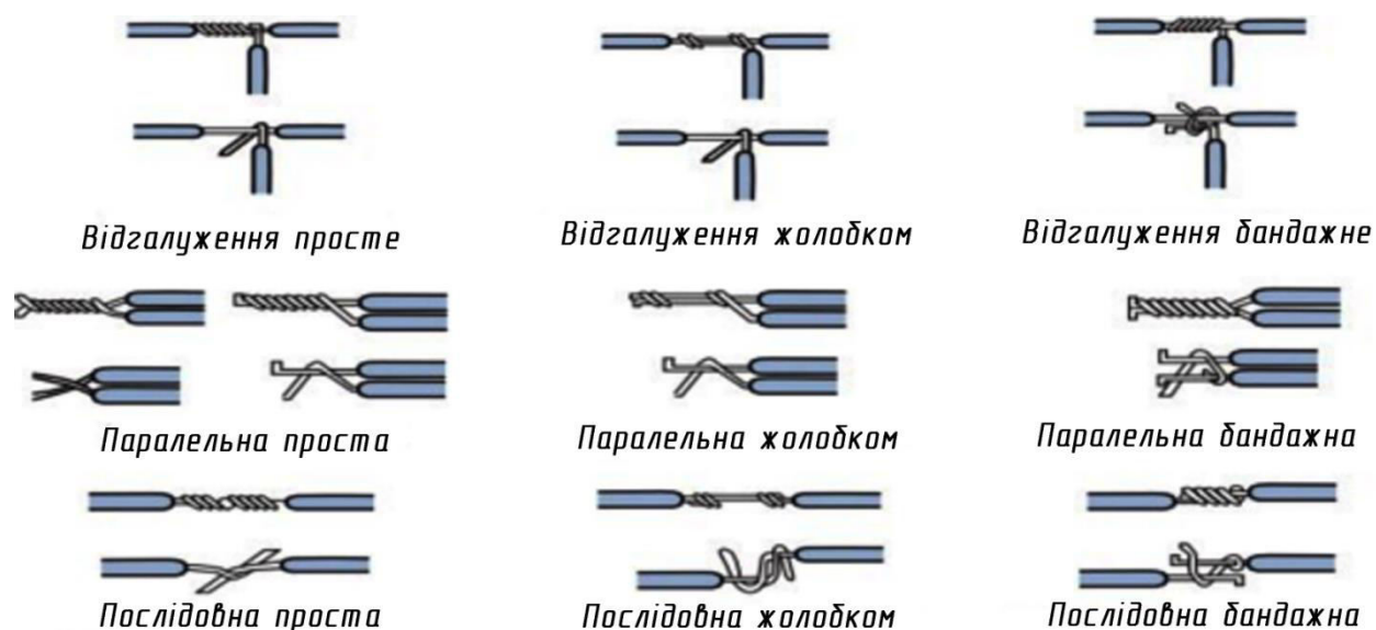
Мал. 28.3. З'єднання мідних жил скручуванням
