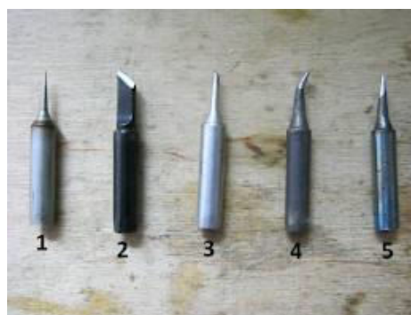
Мал. 30.1. а - паяльник, б - змінні жала паяльника
