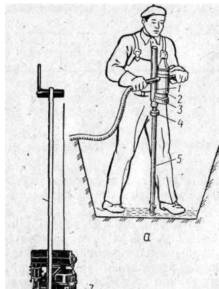
Мал. 35.2. Занурення стержня в ґрунт методом вкручування: а - електросвердлом; б - заглиблювачем ЗЕ-1;
