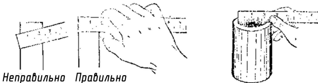
Мал. 4.4 Масштабні металеві лінійки і прийоми вимірювання ними
