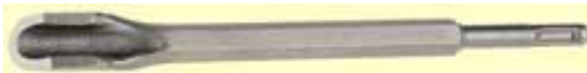
Мал. 43.6. Вирізання каналів під штробу за допомогою штроборіза
