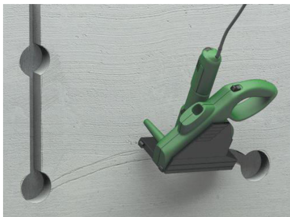
Мал. 43.6. Вирізання каналів під штробу за допомогою штроборіза
