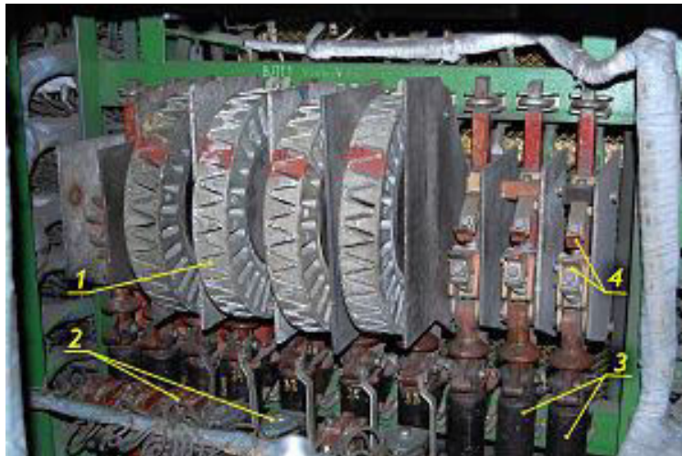
Мал. 50.7. Потужні електропневматичні контактори постійного струму з щілинними дугогасними камерами (1) і без. 2 - електропневматичні вентилі, 3 - циліндри привода, 4 - силові контакти.
