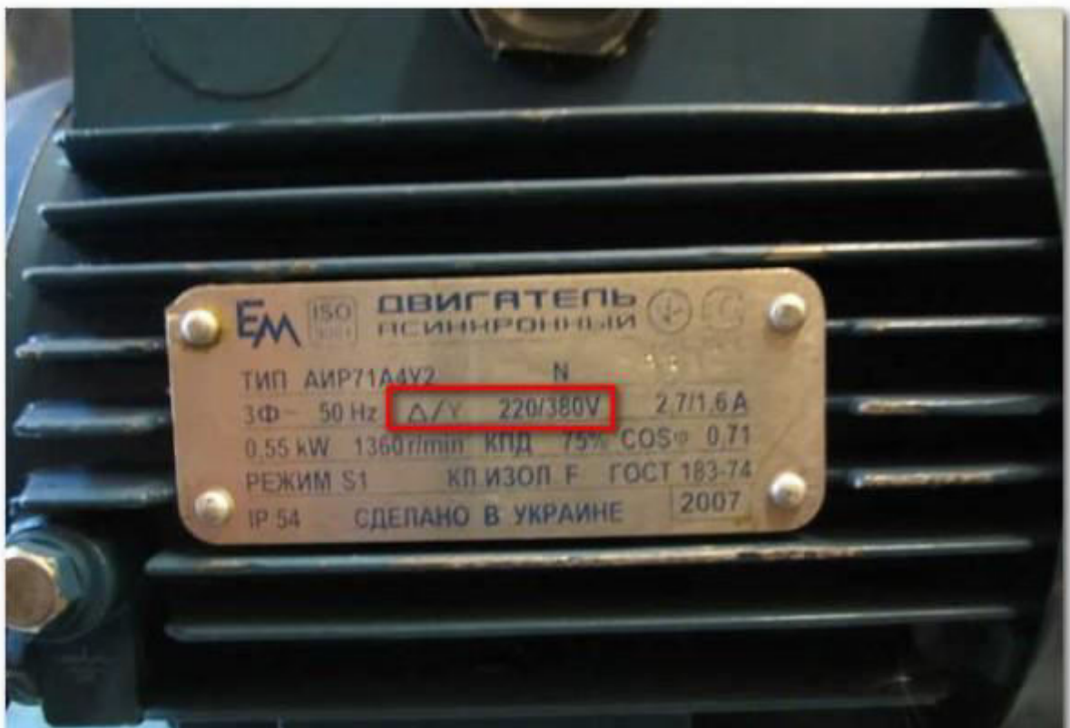
Мал.63.3. Табличка на електродвигуні з вказаними схемами з'єднання статорної обмотки
