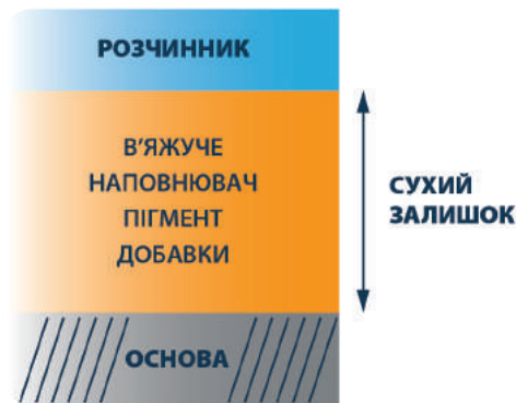
Рис. 1.17. Утворення сухого залишку внаслідок висихання фарби
