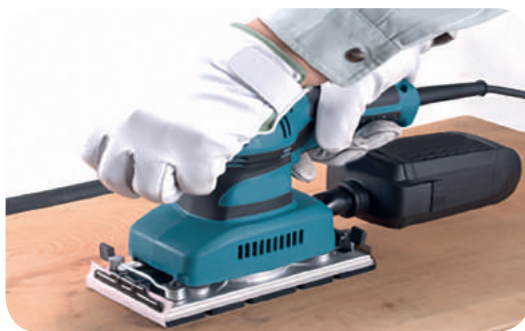
Рис. 7.38. Очищення дерев'яної поверхні за допомогою шліфувальної машини
